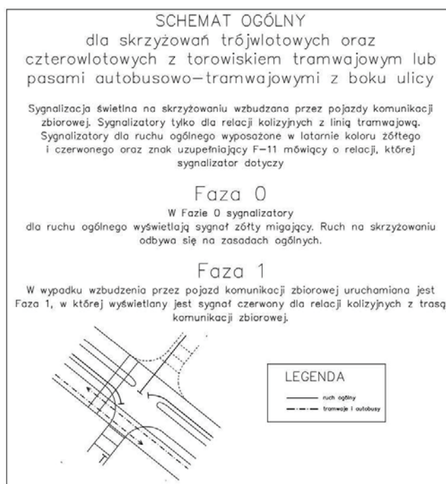
Rys. 7. Schemat ogólny faz ruchu sygnalizacji świetlnej wzbudzanej na skrzyżowaniach bez sygnalizacji stałoczasowej
