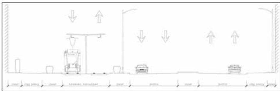
Rys. 2. Schemat przekroju poprzecznego ulicy z torowiskiem tramwajowym obok jezdni
