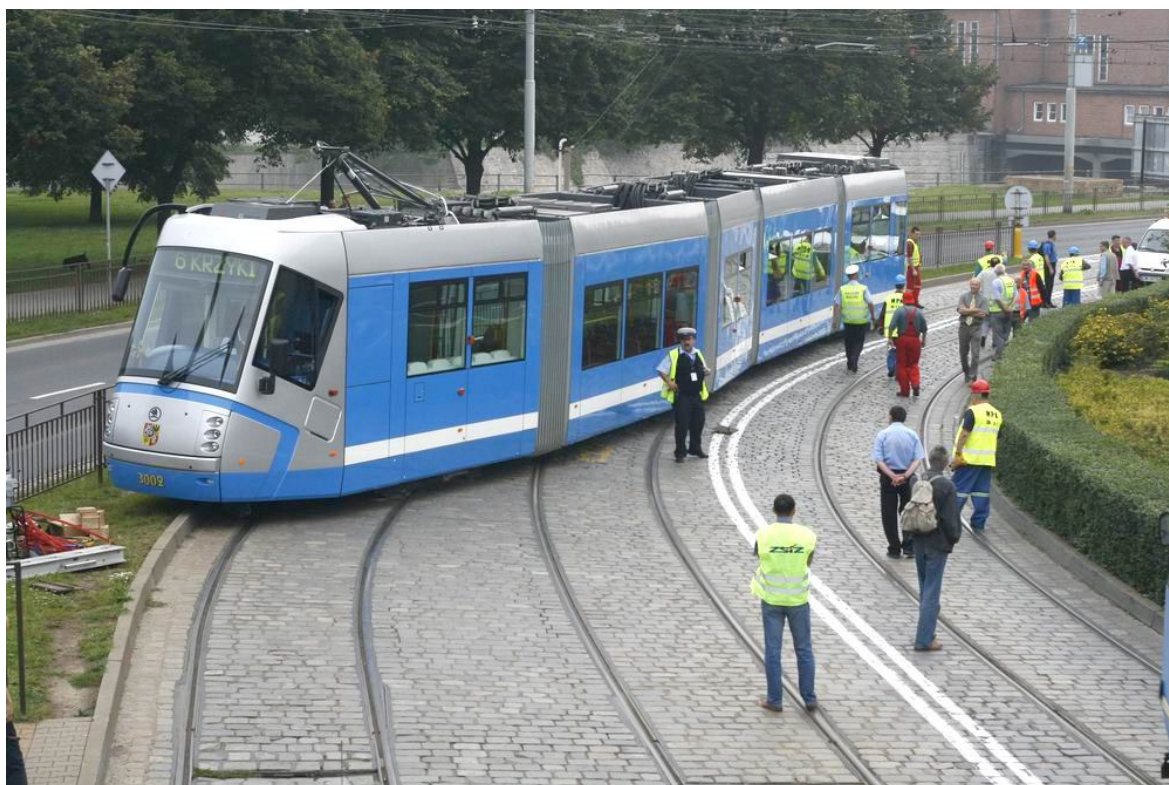
Fot.3 Pierwsze wykolejenie [2]
