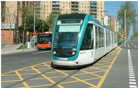
Rys.14 Odmienny sposób oznakowania poprzecznych przejazdów przez pasy ruchu przeznaczone wyłącznie dla pojazdów komunikacji zbiorowej: Barcelona (z lewej) i Nancy (z prawej)
