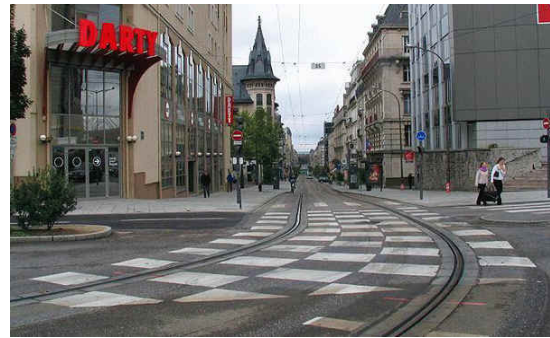
Rys.14 Odmienny sposób oznakowania poprzecznych przejazdów przez pasy ruchu przeznaczone wyłącznie dla pojazdów komunikacji zbiorowej: Barcelona (z lewej) i Nancy (z prawej)
