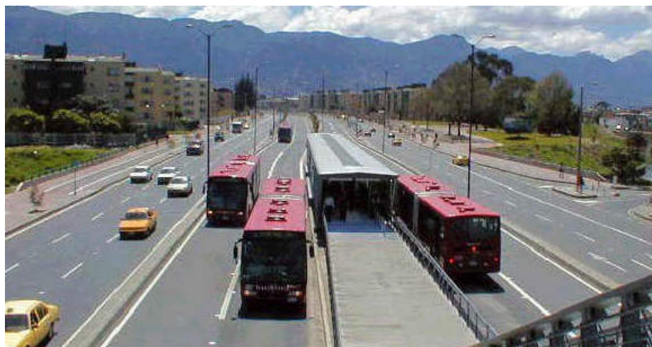
Rys.31 Bogota - pasy autobusowe zewnętrzne dla linii ekspresowych, wewnętrzne - dla zwykłych [8]
